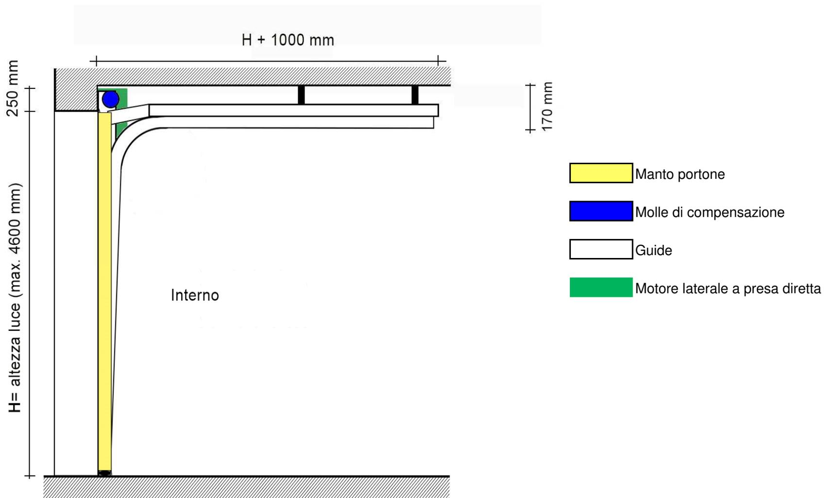
Sistema S11: "INCLINATO" con architrave da mm 500;
